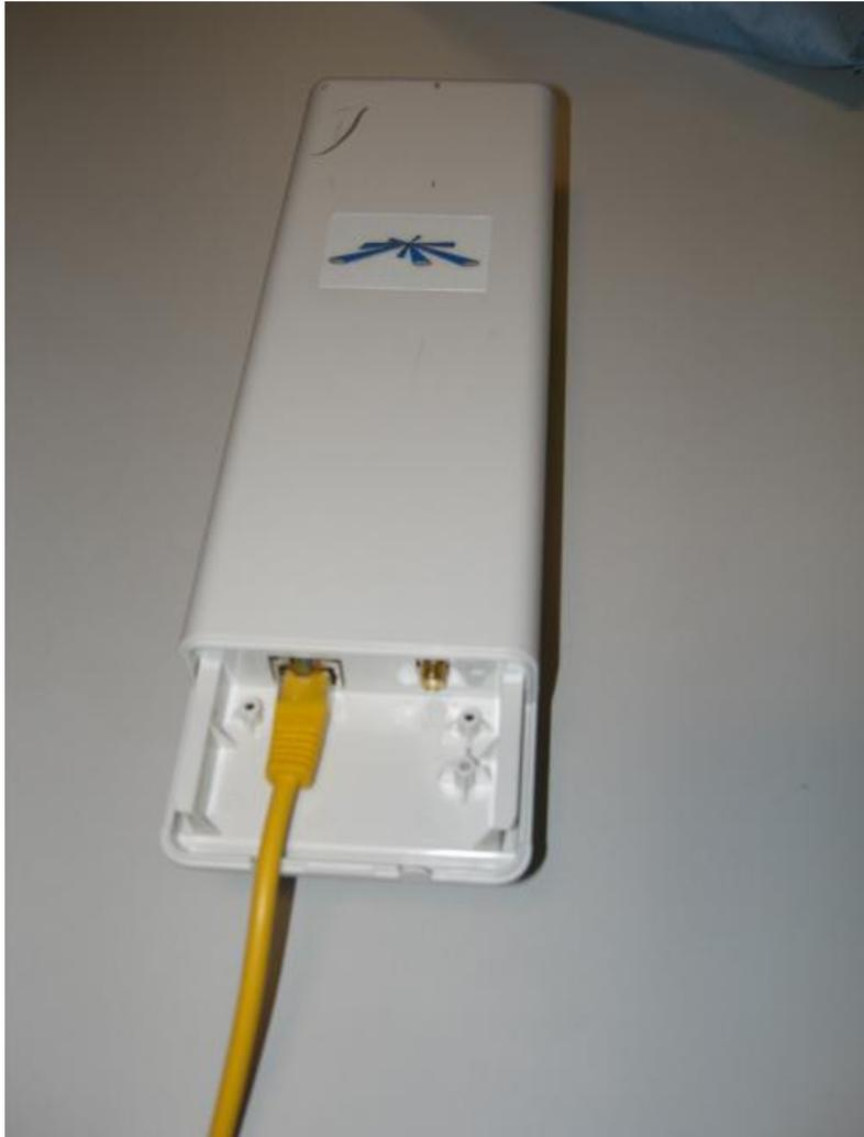
Equipement wifi pouvant être modifié sur les bandes amateurs, très utilisé en Allemagne.
